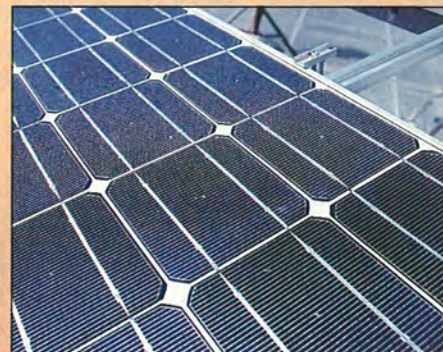
Umwandlung von Sonnenlicht in Strom: Dies geschieht zurzeit üblicherweise mittels mono- (gleichmässiges Blau, oben) oder polykristalliner Siliziumzellen (Bild unten).
