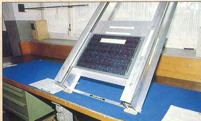
Solarzellen als Ziegel: Solarzellen werden gleich zu «Ziegelementen» gefertigt, so dass keine «Doppelbedeckung» der Häuser mehr nötig wird (Versuchsanlage).
